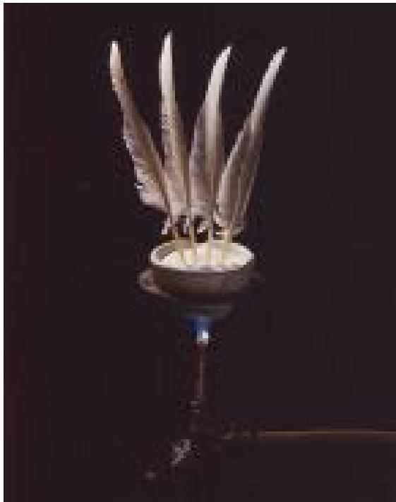
Härten der gewässerten Gänsekiele in erhitztem feinem Sand.
